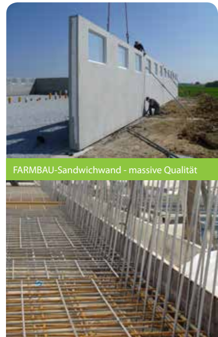
Wandbewehrung im Fertigteilwerk
